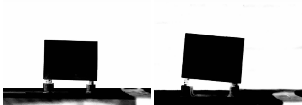
图 8 20m/s 和 40m/s 侧风时实验拍摄的模型位移型态 Fig. 8 Experimental deformation under 20m/s and 40m/s crosswind
