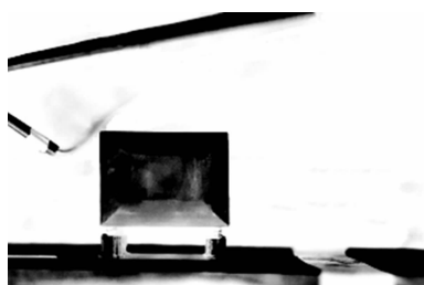
图 7 烟流导入装置 Fig. 7 Plume-tracer technique
