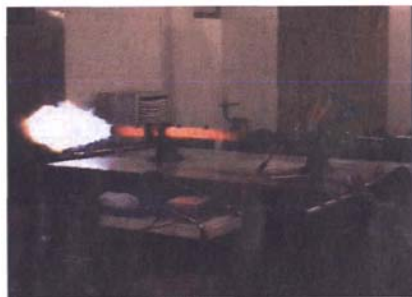
图 7 内径 60mm 的 PDE 试验照片(爆震频率为 42Hz)
