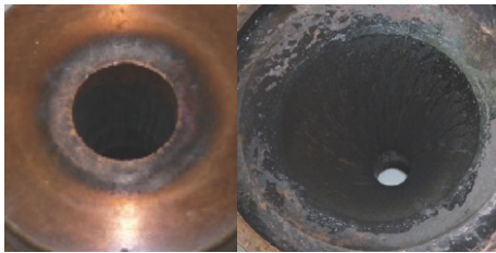
图9 试验后的喷管 Fig. 9 Nozzle after test
